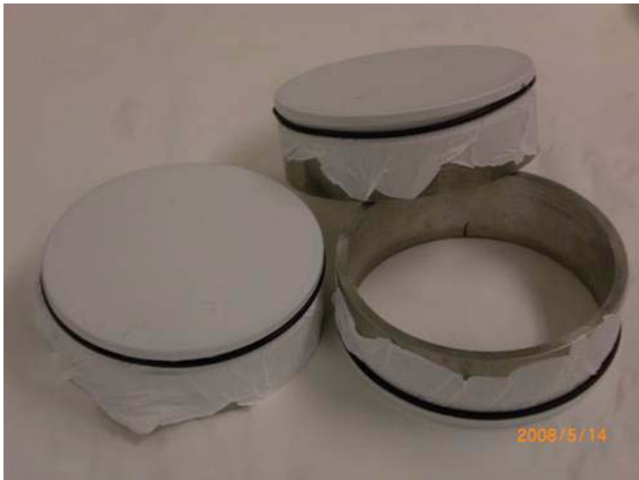
Provhållare med uppspant goretex-membran.
